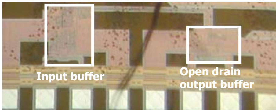
그림 3.13 (b) LVDS(input) - Open drain(output) layout.
